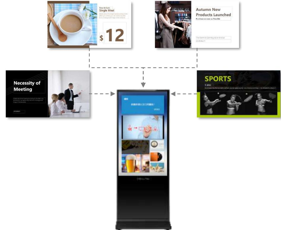
Después de que los programas se envíen a las terminales, el material se almacenará en las terminales localmente. Entonces, después, incluso si la conexión entre HikCentral FocSign y los terminales está apagada, **los programas seguirán reproduciéndose normalmente.**
